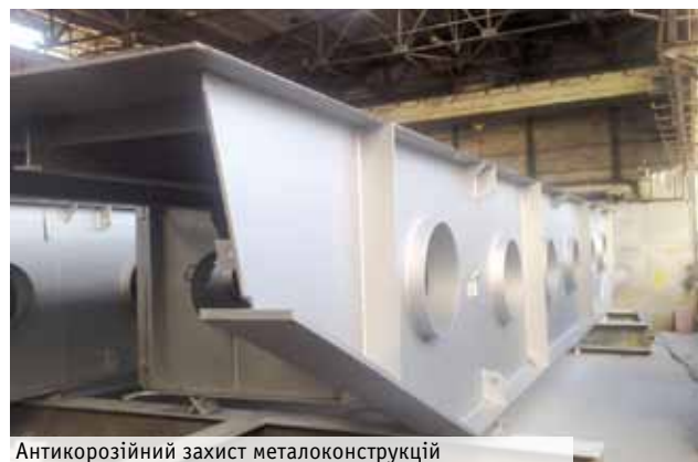
Антикорозійний захист металоконструкцій гідромеханічного обладнання для ГЕС
