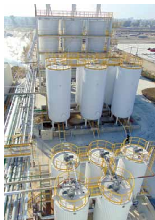
Блок зберігання карбамідоформальдегідної смоли і карбамідоформальдегідного концентрату
