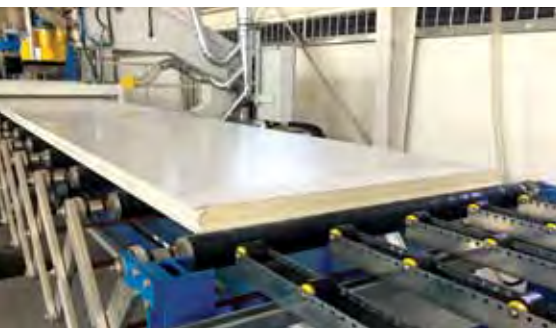
Геометрія панелі формується в процесі руху в 26-метровому гусеничному пресі
