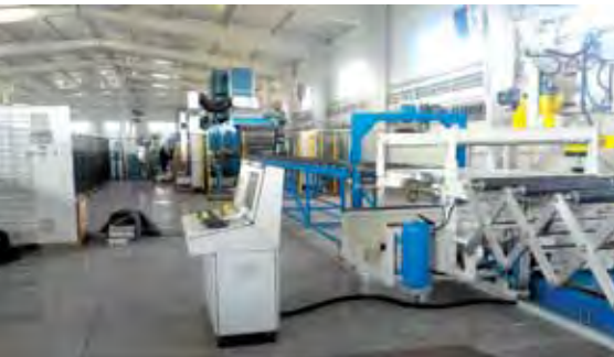
Усе обладнання – від розмотування і обробки листа до нанесення піни – має єдину систему управління
