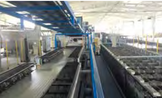
Стан профілювання металевих листів укомплектований валами, що визначають форму готової панелі
