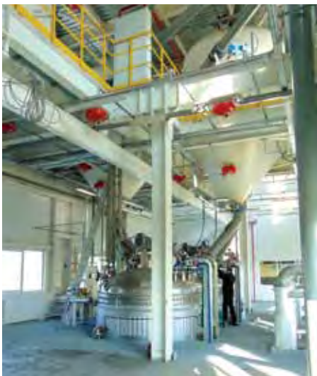
Вузол завантаження сировини (карбаміду/меламіну) в реактор приготування смоли
